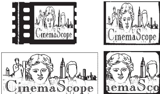
Komprimirani CS fotogram i dekomprimirana projekcija, te komprimirana i dekomprimirana CS slika na TV ekranu
